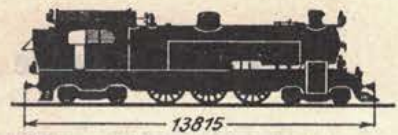
Abb. 4. 2 C 2-Tenderlokomotive mit Überhitzer, 78 t Dienstgewicht (1921).
