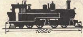
Abb. 14. B + B 1 Mallet-Tenderlokomotive, 42 t Dienstgewicht (1900).
