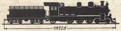
Abb. 7. 2 C 1-Schnellzuglokomotive mit Überhitzer, 88 t Dienstgewicht (1911).
