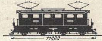
Abb. 23. AA+AA-Güterzuglokomotive, 50 t Dienstgewicht (1925).
