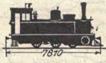
Abb. 13. C-Verbund-Middensoort-Tenderlokomotive, 32 t Dienstgewicht (1896).
